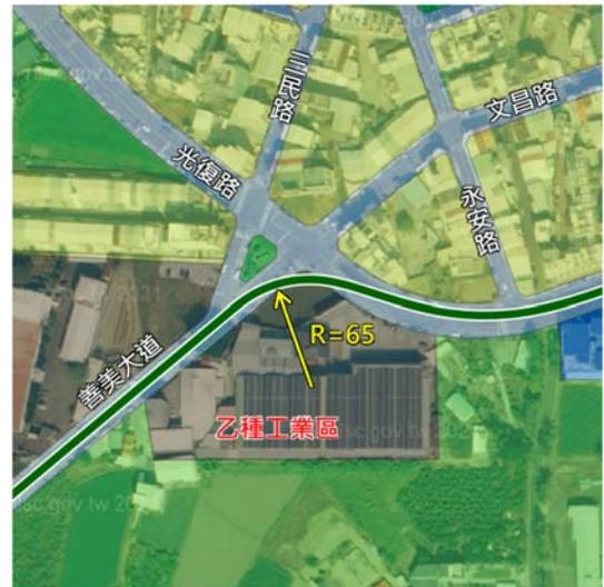
圖 4.1-8 善美大道/光復路轉彎檢核示意圖
