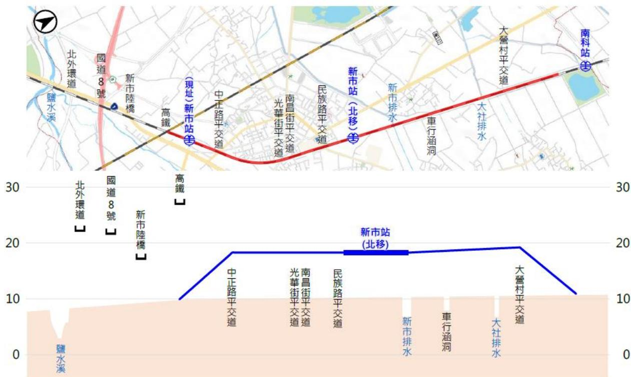
圖 1 新市鐵路立體化方案平縱面示意圖
