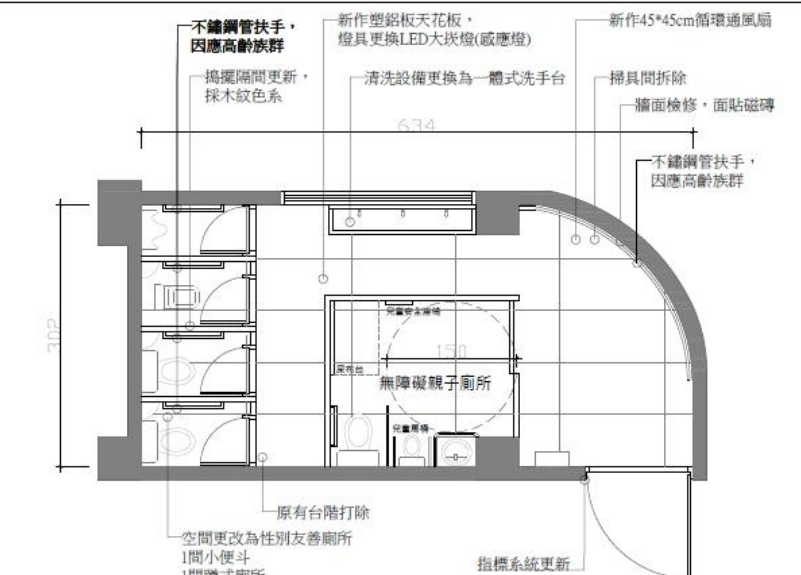
左側性別友善及無障礙親子廁所平面圖 S=1/50(A3) 地坪面積18.4M2 牆面面積55.74M2
